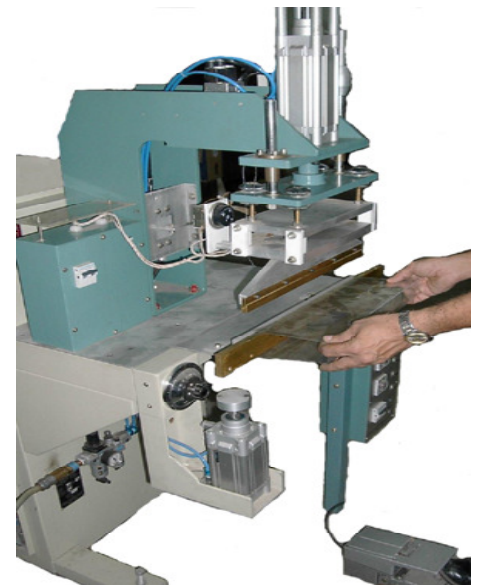
Soudage de manchettes avec une contre-électrode en porte-à-faux et un vérin pour compenser la pression
