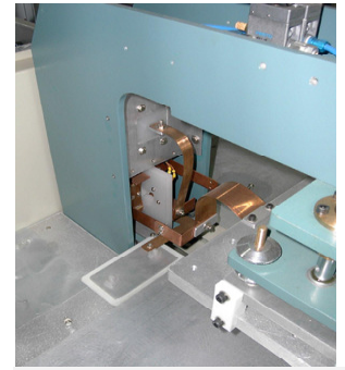
Interrupteur HF en sortie du générateur
