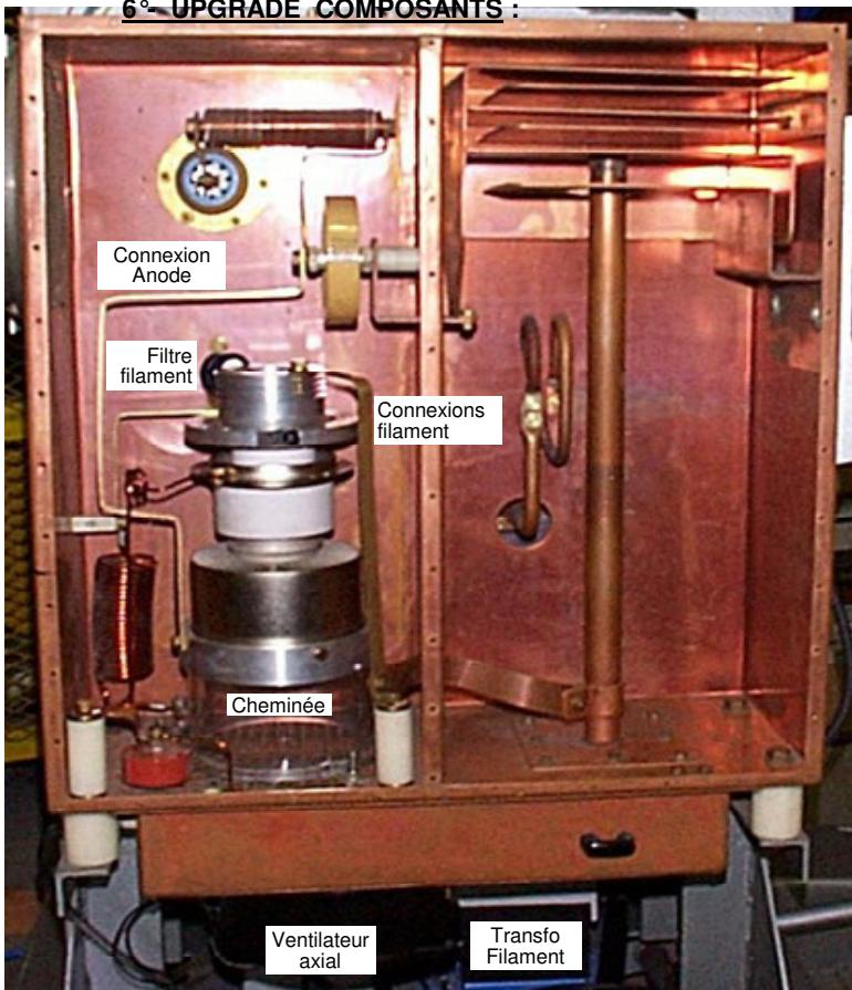
**UPGRADE d'une soudeuse SEF-2500w** : Il est souvent possible d'augmenter la puissance de la cavité en changeant le tube.
