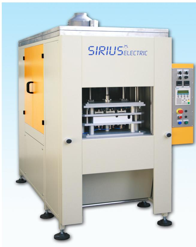
Parmi les types de soudeuses proposées, il y a la soudeuse à lame chauffante LINEAIRE connue pour sa fiabilité et solidité. Elle a été conçue grâce aux technologies de production les plus récentes, elle est de très bonne qualité et a une capacité de production importante.
