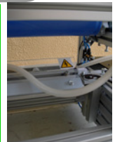
Vue de Détail: Vérin Détecteur de bourelet Butée de réglage Détecteur rotation
